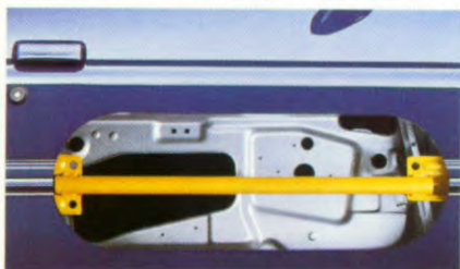
Ieder zijportier heeft een balk van hoogwaardig staal
