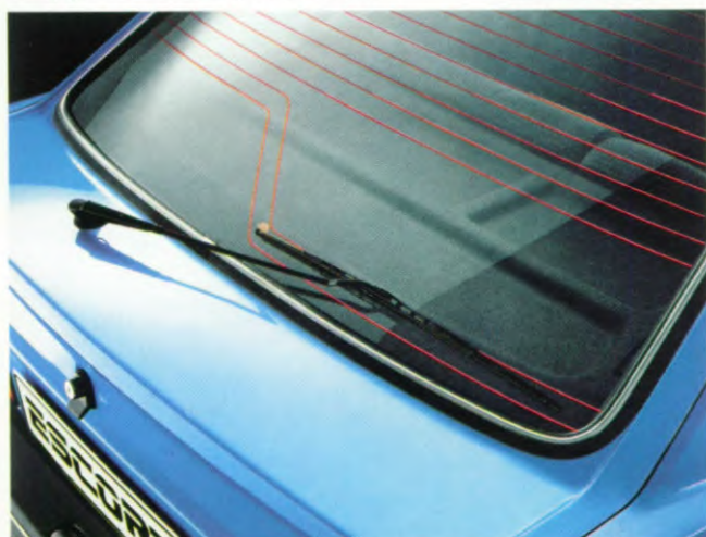
Radio-antenne in verwarmingselement, wis-was installatie.
