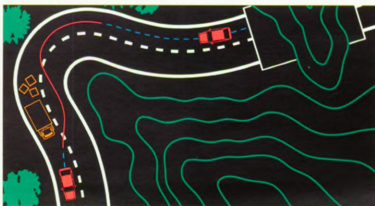
Het als optie leverbare anti-blokkeer remsysteem (ABS) draagt ertoe bij dat de auto bij een noodstop normaal bestuurbaar blijft.
