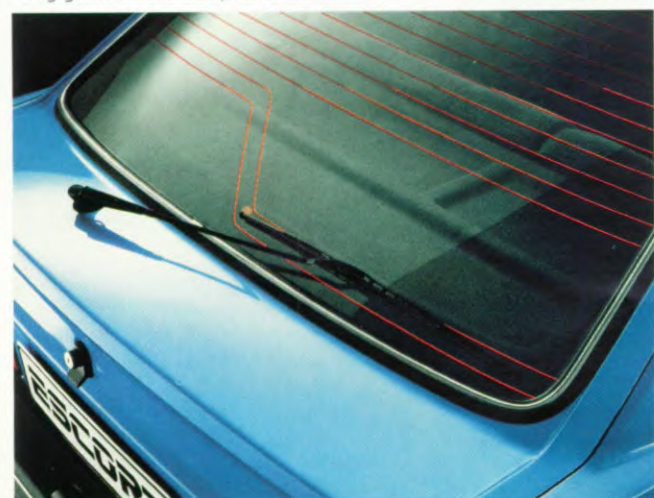
Radio-antenne in verwarmingselement.
