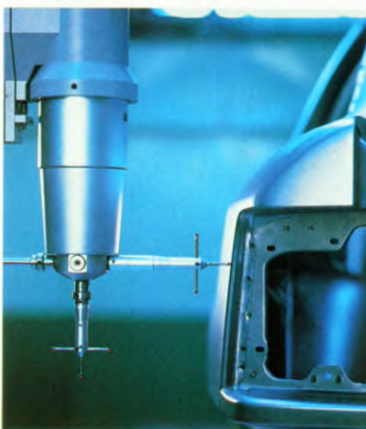
Een computergestuurde kop controleert alle vitale maten van de carrosserie.
