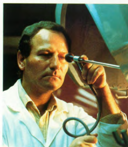
Controle van een holle ruimte na behandeling met anti-roest was.
