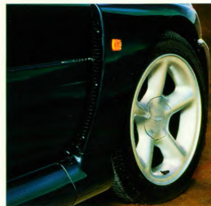
Boven: De luchtuitstroomopeningen in de voorspatschermen dragen bij aan de afkoeling van de motor.
