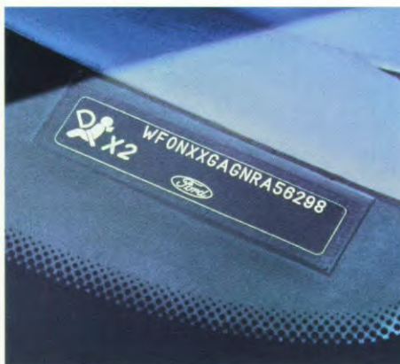
Zichtbaar chassisnummer (VIN). Het chassisnummer is bovenop het dashboard bevestigd en is een effectief afschrikmiddel voor potentiële dieven.
