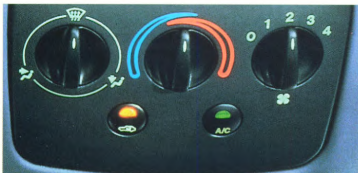
De als optie leverbare airconditioning van de Courier kan worden bediend met één enkele drukknop.
