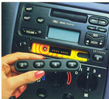
Audiosystemen. Alle apparatuur is voorzien van een unieke viercijferige pincode. Dit werkt diefstalremmend want het maakt gebruik na diefstal onmogelijk.
