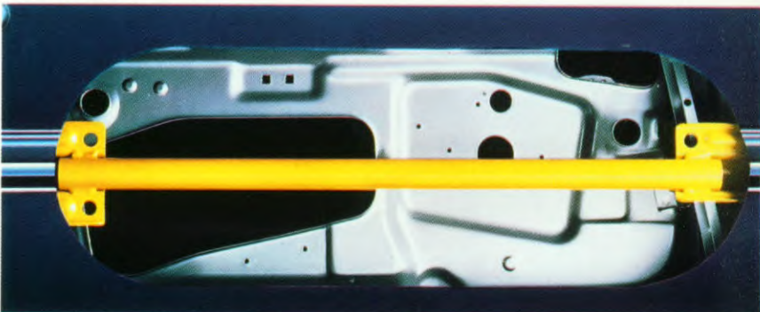
Stalen versterkingsbalk in het portier van de Escort Van.
