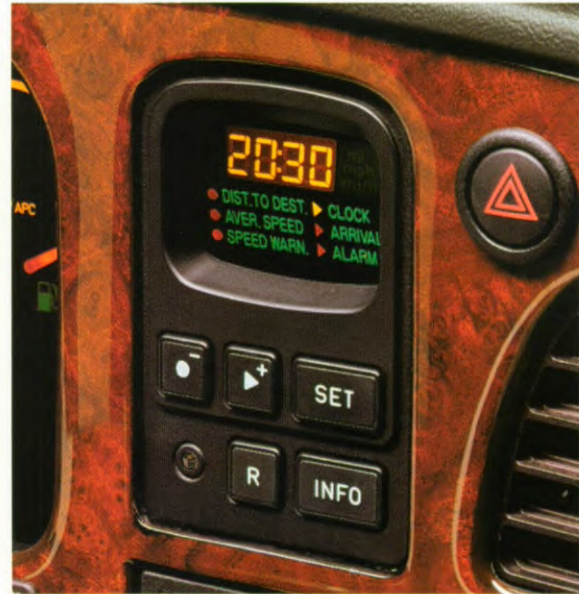
De SCC, Saab Car Computer (standaard op bepaalde modellen), helpt u bij het plannen van uw reis. De SCC geeft niet alleen de tijd aan maar ook de gemiddelde snelheid, de resterende afstand tot de plaats van bestemming, de verwachte aankomsttijd, enz.
