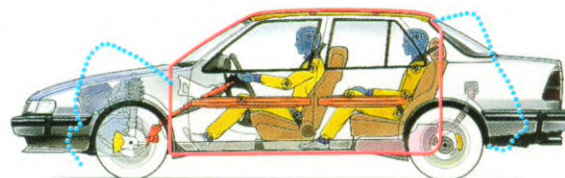
In een Saab 9000 zorgen grote kreukelzones voor en achter voor de bescherming van de inzittenden.
