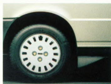
De wielspoiler achter en vlakke wioldoppen: twee voorzieningen om luchtwervelingen te elimineren en dus de luchtweerstand te verlagen voor een beter aerodynamisch effect. Resultaat: een nóg lagere Cx-waarde van 0,33.
