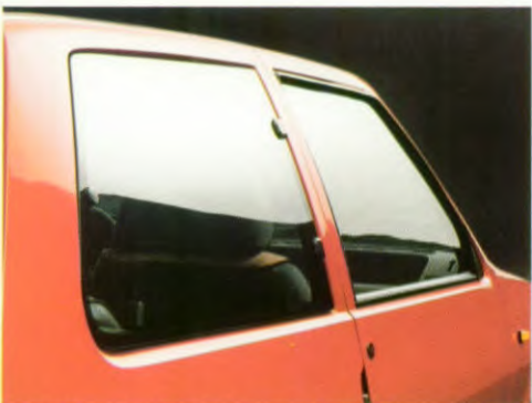
De ruiten sluiten exakt aan bij de buitenzijde van de karosserie. Bij de 3-deurs uitvoeringen zijn als extra uitklapbare zijruiten achter verkrijgbaar.
