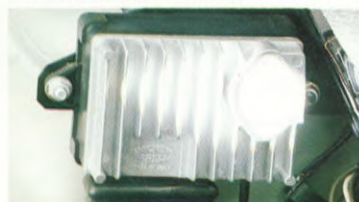
De elektronische ontsteking optimaliseert verbruik en prestaties door continu nauwkeurige bepaling van het gunstigste ontstekingstijdstip.
