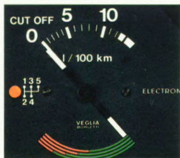
De elektronische verbruiksmeter. Een instrument met een dubbel uitgevoerde schaal dat zich instelt op de rijstijl van de bestuurder en deze met een verknikkerlicht waarschuwt om over te schakelen.
