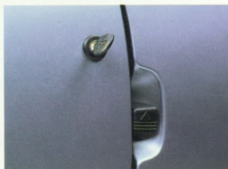
Centrale portiervergrendeling: u sluit alle deuren af door slechts één van de voordeuren af te sluiten.
