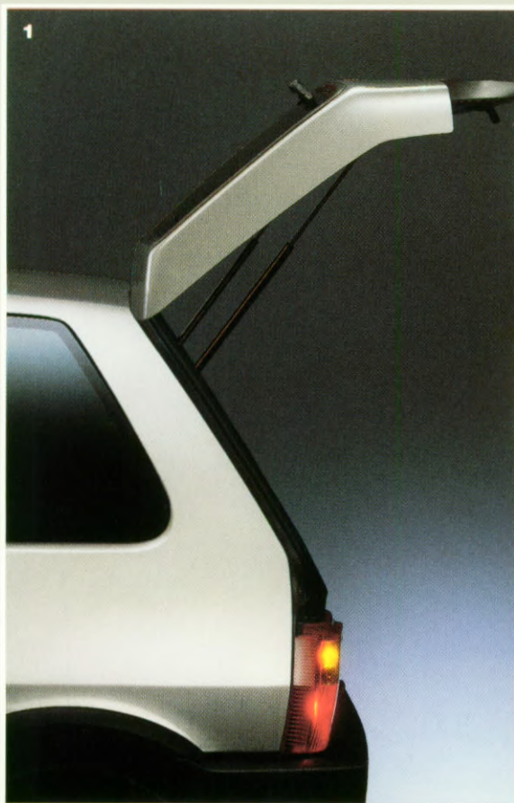
1. Achterklep van dubbelzijdig verzinkt plaatwerk, met wijde openingshoek en in evenwicht gehouden door hydraulische dempers.
