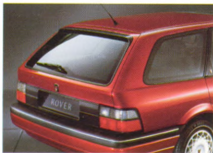
D e antenne is aan de achterzijde van het dak gestueerd, voor een esthetisch verantwoorde, optimale ontvangst.
