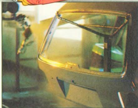
Le fasi di lavorazione automatica del portellone posteriore della "Tito" prevedono: stampaggio, sbavatura, foratura per fissare le parti accessorie, incollaggio dei due gusci costruttivi della struttura, lavorazione della pelle esterna. Nella foto accanto, la verniciatura finale.
