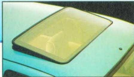
*Il tettuccio apribile può essere montato, a richiesta, su tutte le versioni della "Tipo". Per la "DGT" è disponibile anche con comando elettrico. Il tettuccio è del tipo a doppio movimento: basculante (sopra) oppure scorrevole (sotto).*
