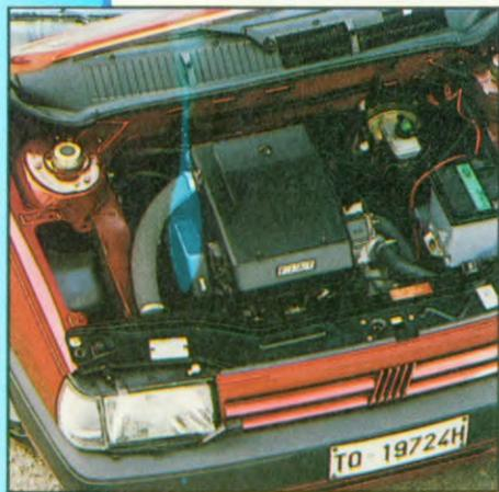
*Sopra, il motore a benzina di 1400 cc; a destra, il turbodiesel. In entrambi i casi, gli intervalli fra le operazioni di manutenzione programmata hanno una cadenza di ventimila chilometri. Più ravvicinati, invece, soprattutto per i Diesel, i cambi dell'olio.*
