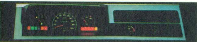
1) Contachilometri totale e parziale. 2) Tachimetro. 3) Livello carburante. 4) Termometro acqua. 5) Econometro. 6) Orologio. 7) Regolazione luce strumenti. 8) Selettore contachilometri. 9) 11) 13) Spie luci. 15) Spia lunotto termico. 17) Spia retronebbia. 10) Spia batteria. 12) Spia pressione olio. 14) Spia freni. 16) Spia usura pastiglie. 18) Luci di emergenza. 19) Contagiri. 20) Check panel.
