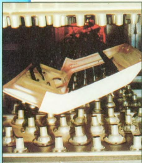
*Il portellone posteriore in ZMC (poliestere termoindurente) durante una fase della lavorazione automatica nello stabilimento di Cassino.*
