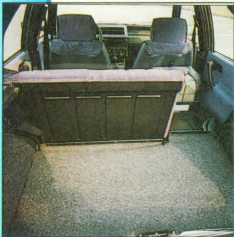
*A richiesta, la "Tipo" può essere fornita con il sedile posteriore sdoppiato in modo asimmetrico, con la parte più larga dietro il posto del guidatore. Questa soluzione aumenta la versatilità della vettura nel trasporto bagagli.*
