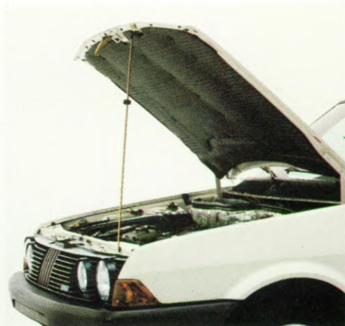
Motorruimte geheel bekleed met geluid-dempend materiaal.
