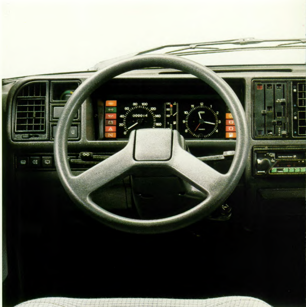
Overzichtelijk dashboard, modern en funktioneel ontwerp van zeer hoogwaardige, kras- en slijtvaste kunststof met optimale schokabsorberende eigenschappen voor verhoogde veiligheid. Het dashboard omvat behalve het eerder genoemde quartz-klokje ook een watertemperatuur-
