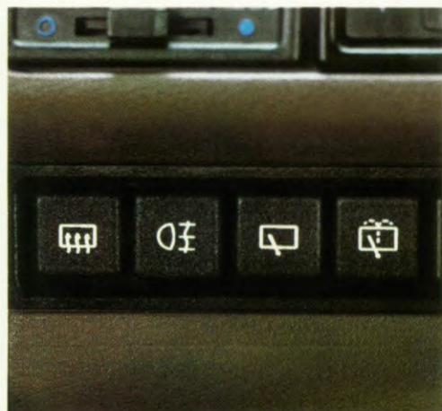
Drukknopschakelaars met geïntegreerde, verlichte functie-aanduiding.
