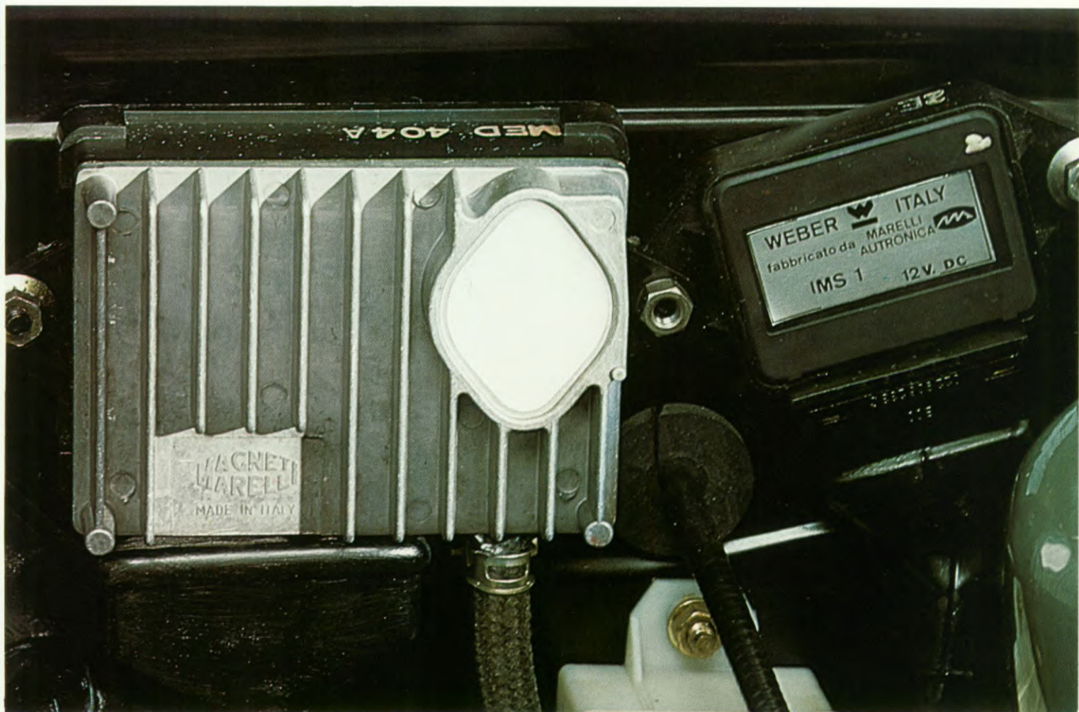
Zeer geavanceerde Marelli Digiplex ontsteking, zoals die alleen standaard op exclusieve auto's, zoals bijvoorbeeld Ferrari wordt toegepast. Draagt bij tot vermindering van het brandstofverbruik door bijzonder nauwkeurig ontstekingstijdstip bij alle bedrijfsomstandigheden van de motor.
