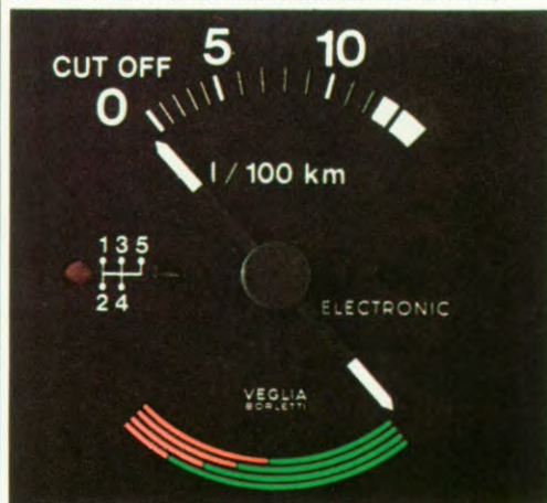
Elektronische verbruiksmeter voor verbruiks-indikatie in alle versnellingen.
