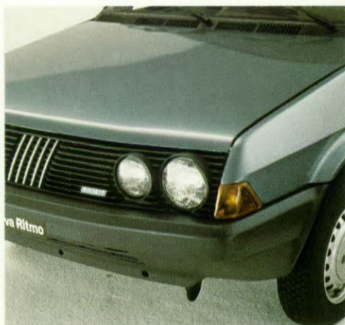
Robuuste, opzij doorlopende bumpers van een gloednieuwe konstruktie: elastische, oersterke kunststof kokerprofielen.
