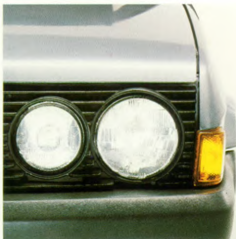
Strak front met 4 koplampen, waarvan 2 met halogeen-units.
