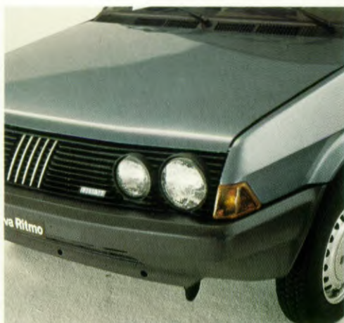
Nieuwe, opzij doorlopende bumpers van een gloednieuwe constructie: elastische, oersterke kunststof kokerprofielen.
