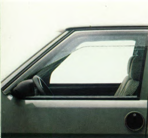
Speciale anti-luchtwervelingskappen op de ramen van de voorportieren.
