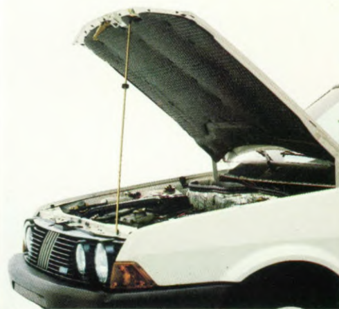
Motorruimte geheel bekleed met geluid-dempend materiaal.
