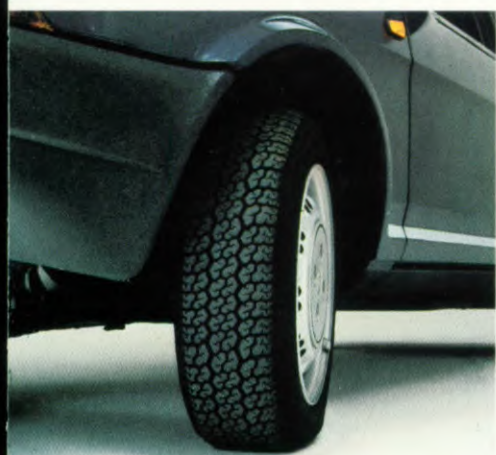
Velgen met vergrote diameter, voorzien van laagprofielbanden.
