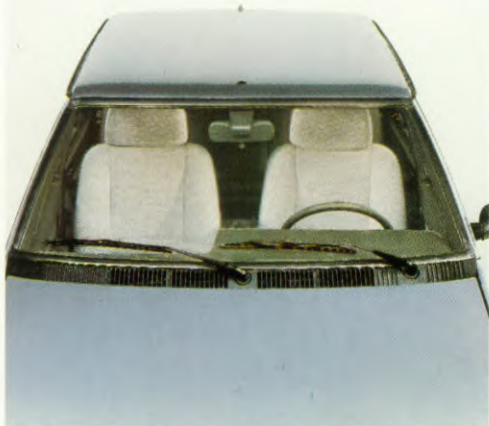
Nieuwe, aërodynamisch gevormde luchttoevoeropening langs de volle breedte van de voorruit.
