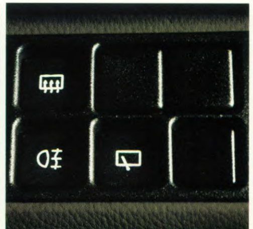
Drukknopschakelaars met geïntegreerde, verlichte functie-aanduiding.
