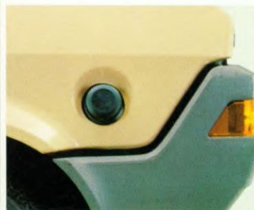
Specialiteit in de Ritmo: anti-diefstal rooster in de hals van de benzine-leiding.
