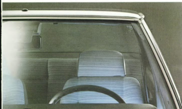
De voorruit is van gelaagd glas voor extra veiligheid.
