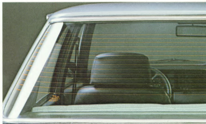
De elektrisch verwarmde achterraut reukt onmiddellijk af met wasem en ijsafzetting.
