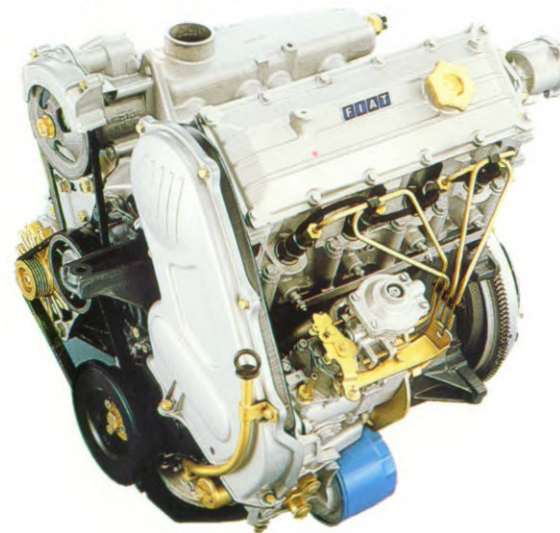
De nieuwe Regata Turbo Diesel motor met intercooler: 1929 cc., 59 kW (80 DIN PK), 170 km/u.
