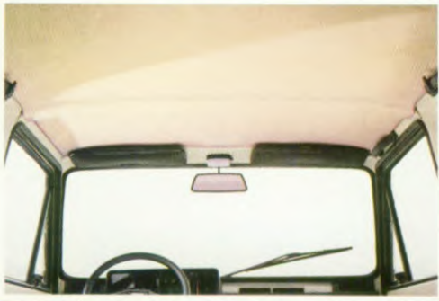
Luxe, optimaal isolerende, uit één stuk gevormde hemelbekleding.
