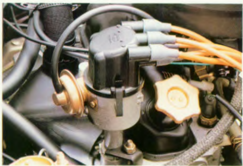
Speciale vacuümvervroeger op de verdeler voor optimale ontstekingstijdstippen met een nog zuiniger verbruik als resultaat.
