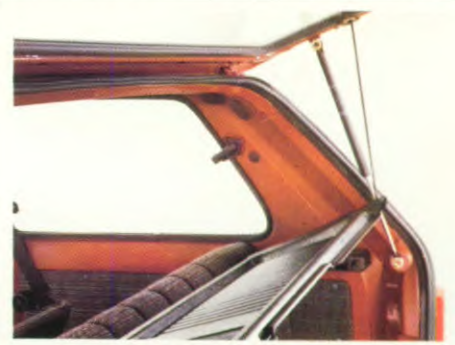
Nieuwe hoedeplank die tegelijk met het openen van de achterklep omhoog gaat.
