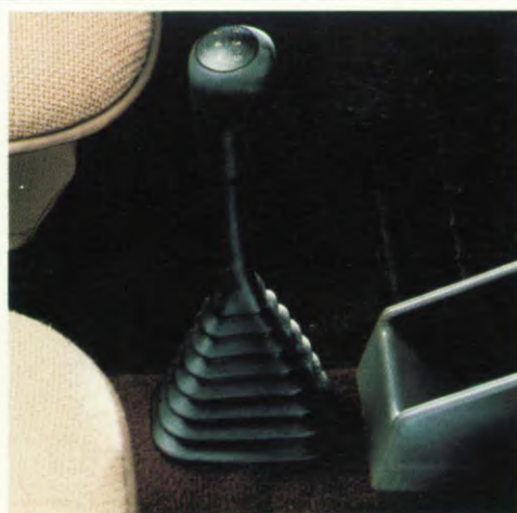
5-versnellingsbak (als extra leverbaar) voor minder motorgeruis en een lager brandstofverbruik.
