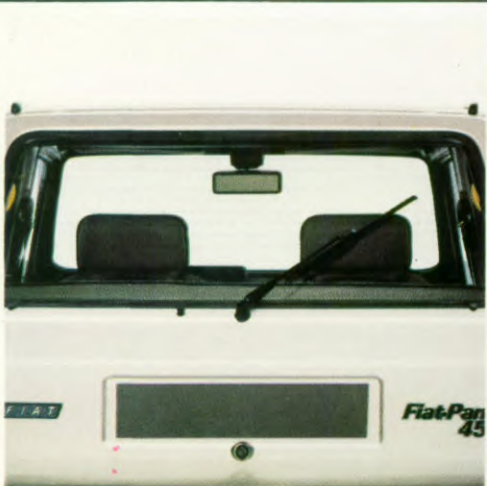
Elektrisch verwarmde achterraut met wis/wasinstallatie.
