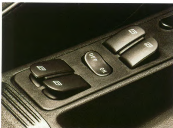
ELEKTRISCH BEDIENDE RAMEN. De werking van de schakelaars is logisch: indrukken om de ramen te openen en omhoog brengen om de ramen dicht te doen. Met kinderbeveiliging voor de zijramen achter.
