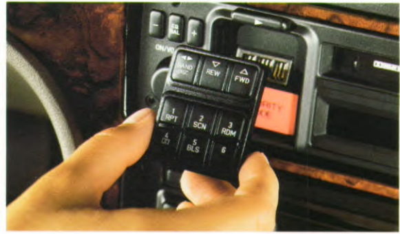
Met een afneembaar front en een veiligheidscode is de radio-cassettespeler beveiligd tegen diefstal.
