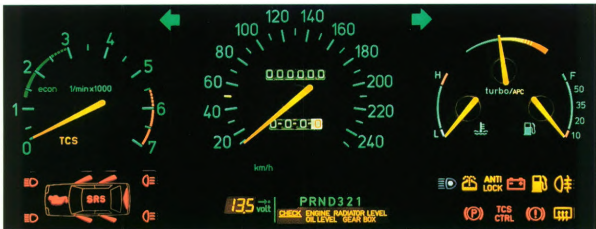
De instrumenten worden door indirect groen licht verlicht, een kleur die in het donker beter zichtbaar is dan rood. Het grafische pictogram en de waarschuwingssymbolen zijn normaal alleen zichtbaar wanneer de betreffende lampjes oplichten.
