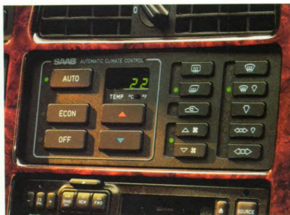
AUTOMATISCHE KLIMAATBEHEERSING (ACC). Handhaaft de door u ingestelde temperatuur. Regelt ook het ontdoeien en ontwasemen. Zonder cfk's natuurlijk.
