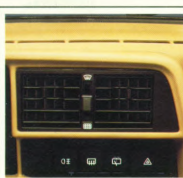
Regelbare verwarming en ventilatie d.m.v. verstelbare roosters; drukknopschakelaars.
