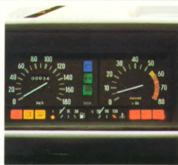
Uitgebreid instrumentenpaneel met o.a. elektronische toerenteller en oliedrukmeter.
