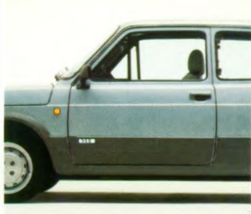
Brede beschermstrips langs de zijkanen van de carrosserie tussen de verbrede wielkasten.
