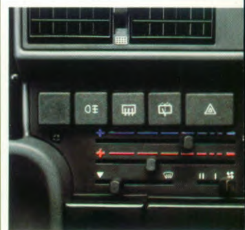
Drie bedieningshandles voor verwarming en ventilatie. Drukknopschakelaars.
