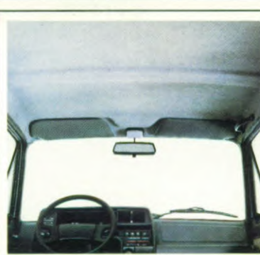
Voorgevormd hemelpaneel, hetwelk optimale geluids- en warmteisolatie garandeert.
