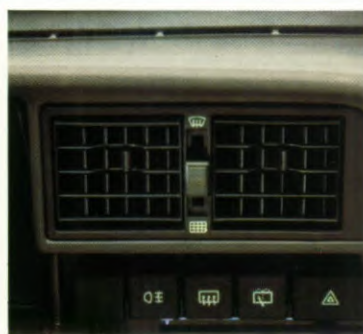
Regelbare ventilatie met verstelbare roosters.
