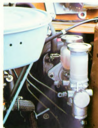
Het remsysteem van de Datsun Sunny Traveller laat zelfs voor de meest verwendende autorijder niets te wensen over. Grote schijfremmen op de voorwielen, rembekrachtiging, gescheiden remsysteem en een remkrachtbegrenzer op de achterwielen, zorgen voor een optimale veiligheid.
