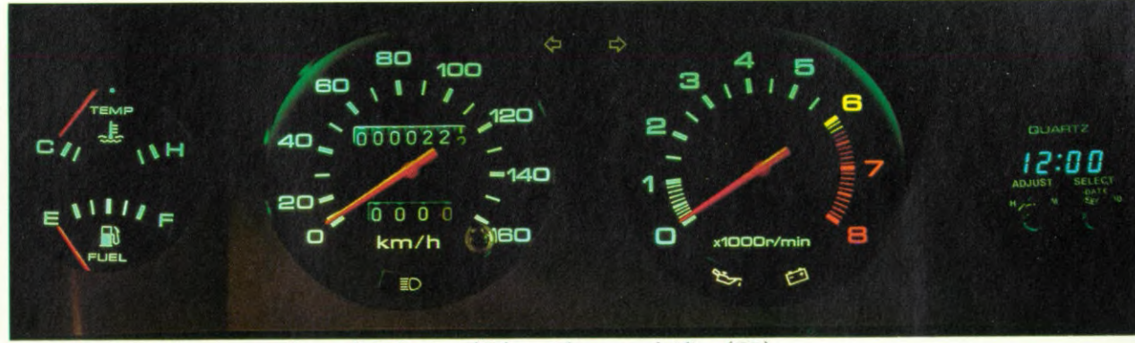
Km-teller met 6 cijfers, toerenteller en digitale quartzklok met datumaanduiding (GL).
