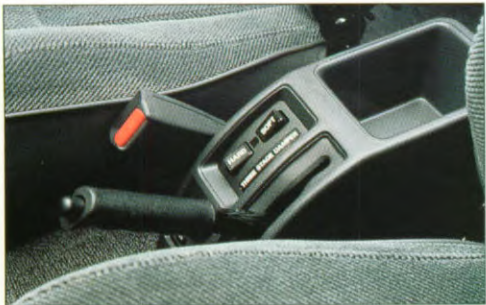
IN 3-STANDEN INSTELBARE SCHOKBREKERS WORDEN VAN BINNENUIT GEREGLD.
