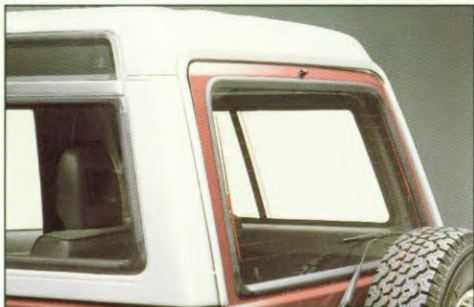
Achterrauitverwarming met wis/was installatie.
