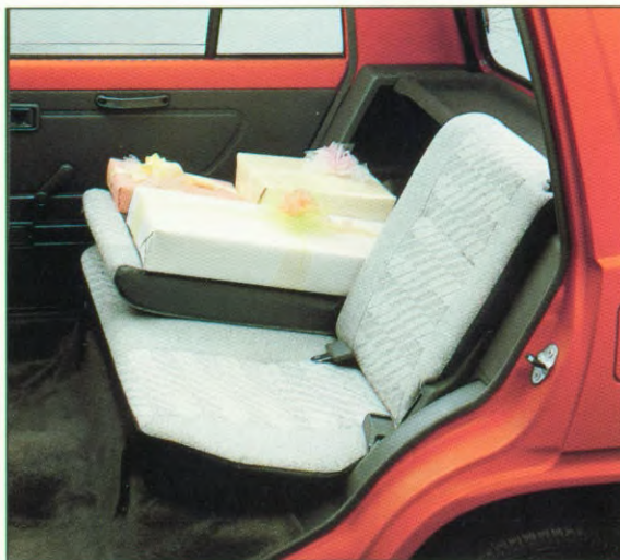
De achterbank (in de modellen TX en CS) is in gedeelten neerklapbaar. Veiligheidsriemen achter zijn niet leverbaar.
