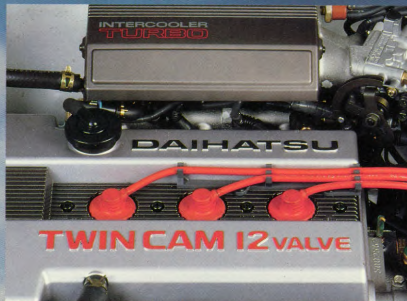
12 KLEPPEN TWIN CAM TURBOMOTOR MET ELEKTRONISCHE BRANDSTOFINJECTIE VOOR DE IDEALE BRANDSTOFMIX.
