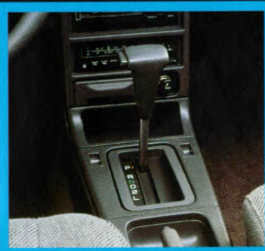
De automatische versnellingsbak heeft drie versnellingen alsmede een "lock-up". Dit systeem voorkomt bij kruissnelheden onnodige slip en verlaagt het brandstofverbruik.
