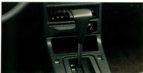
OOK LEVERBAAR ALS AUTOMAAT (3 VERSNELLINGEN) VOOR- ZIEN VAN "LOCK UP" SYSTEEM. BIJ KRUISSNELHEDEN WORDT HIERMEE ONNODIGE SLIP VOORKOMEN EN EEN LAGER BRANDSTOFVERBRUIK VERKREGEN.
