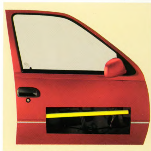
Stevige balken in alle portieren voor een uitstekende bescherming tegen zijdelingse aanrijdingen.
