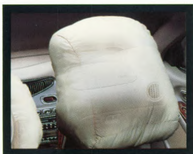
De airbag voor de bestuurder meet 60 liter, die voor de passagier 120 liter
