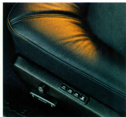
Elektrisch verstelbare voorstoelen dragen bij tot het comfort. Er kunnen drie verschillende standaardinstellingen in het geheugen worden geprogrammeerd. Dit is vooral gemakkelijk wanneer de auto regelmatig door verschillende bestuurders en passagiers wordt gebruikt.
