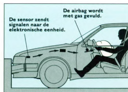
Er zijn 20 milliseconden verstreken sinds het moment van de botsing. De sensoren hebben het systeem geactiveerd en de airbag wordt opgeblazen.
