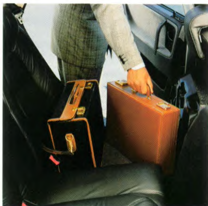
De Saab 9000 CD heeft een verborgen luik in de leuning van de achterbank waarin lange, smalle voorwerpen kunnen worden vervoerd. Een beschermende hoes is als extra uitrusting leverbaar.
