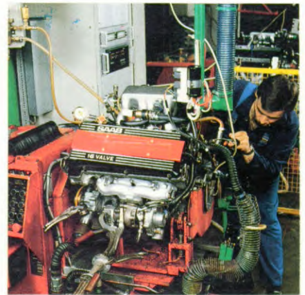
Iedere motor wordt proefgedraaid voordat hij de fabriek verlaat. De werking en de instellingen worden gecontroleerd.
