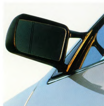
Despeciaal ontworpen buitenspiegels bieden weinig weerstand tegen de luchtstroom waardoor de aërodynamische eigenschappen verbeterd worden en de zijramen schoon blijven.
