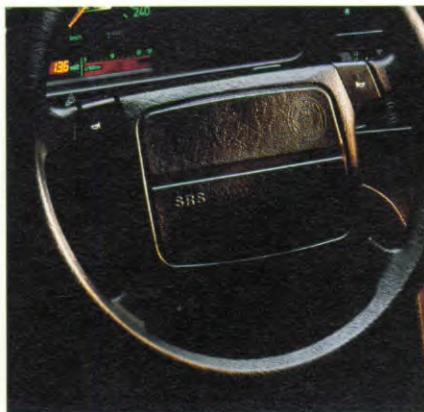
De letters „SRS”, die in reliëf op het stuurwiel zijn aangebracht, duiden aan dat de auto met het Saab SRS systeem is uitgerust.
