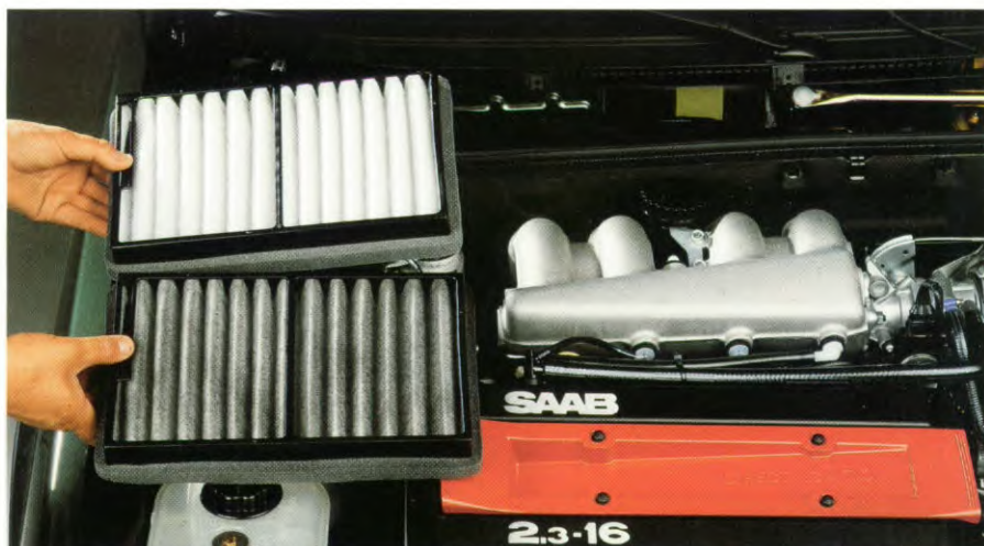
Daar het ventilatieluchtfILTER in de Saab 9000 de meeste deeltjes met een grootte van 0,005 mm tegenhoudt, worden stof, stuifmeel en sommige bacteriën op effectieve wijze door het filter opgevangen. Het vervangen van het filter, dat slechts om de 30.000 km hoeft te gebeuren, is een eenvoudig karwei.
