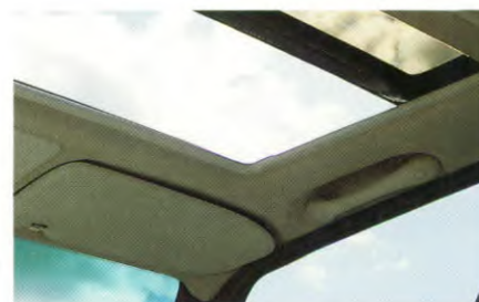
Het open schuifdak zorgt voor een aangename afkoeling en ventilatie. Maar ook in gesloten stand kan het schuifdak het comfort vergroten – mits het van getint glas is. Het maakt het interieur lichter en ruimer. Het zonnergordijn voorkomt dat teveel zonlicht binnendringt en maakt het interieur aangenamer in de winter.
