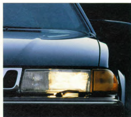
De Saab 9000 CS heeft vier afzonderlijke koplampen, twee voor grootlicht en twee voor dimlicht. Het dimlicht blijft branden wanneer het grootlicht wordt ingeschakeld. In de voorspoiler kunnen mistlampen worden aangebracht.
