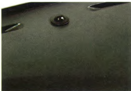
De zonnensensor bovenop het dashboard registreert de stand van de zon en de intensiteit van de zonnestraling.
