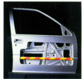
De verstevigingsbalken in de portieren zijn van stalen buizen met een hoge weerstand. Zij bieden de passagiers extra bescherming in geval van een zijdelingse botsing.
