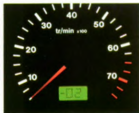
Met de buitentemperatuurmeter in de toerenteller wordt u nooit verrast door gladheid.
