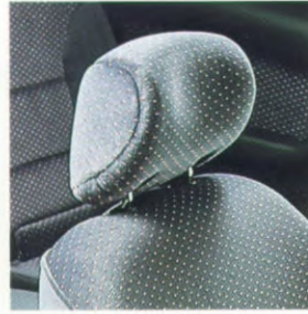
Hoofddeunen op de voorstoelen zijn in hoogte verstelbaar.
