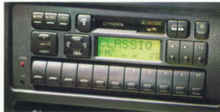
RDS voorziening op Blaupunkt radio type 3030 en type 4030.
