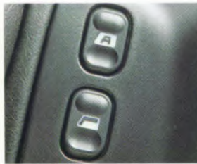
Bij de toetsen voor de elektrisch bediende zijruiten vóór zit een toets met tipbediening voor de ruit aan bestuurderszijde.
