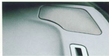
Hoge tonen luidsprekers (tweeters) bevinden zich op het dashboard.
