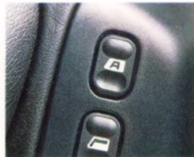
Elektrisch bedienbare zijruiten vóór met tipbediening.
