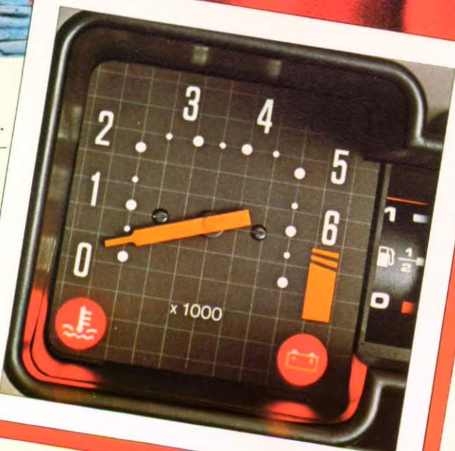
*Moteur : 1219 cm<sup>3</sup>. 7 CV. Puissance maxi à 6000 tr/mn : 64 ch DIN. 4 cylindres. Allumage transistorisé. Refroidissement par eau. Freins assistés. Freinage rapide et sans effort.*
