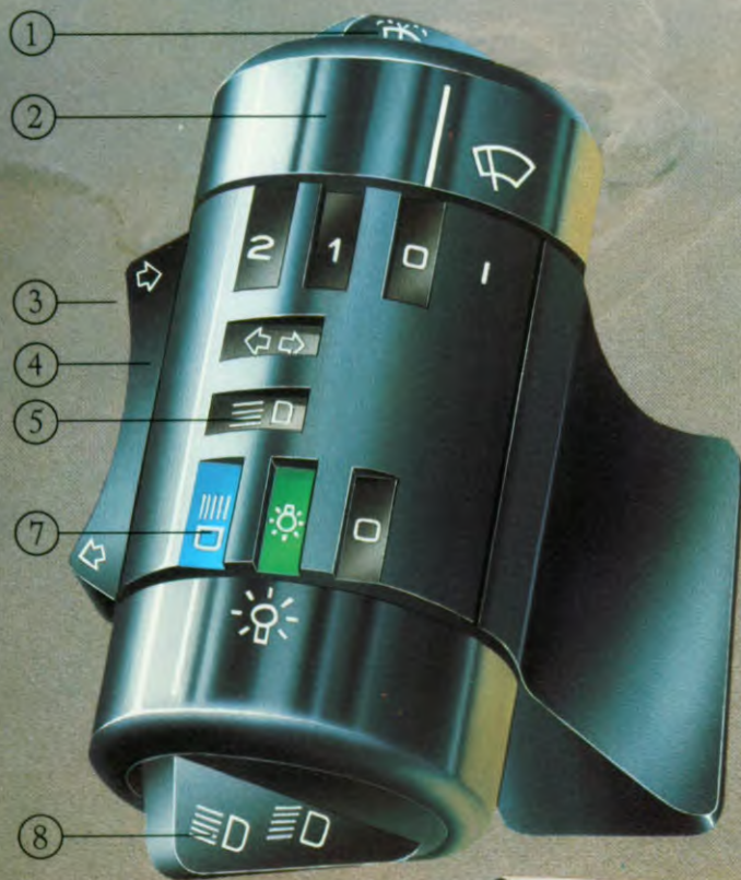
1 Ruitersproeier. 2 Ruitewisser. 3 Claxon. 4 Richtingaanwijzers. 5 Dimlicht. 7 Grootlicht. 8 Lichtsignaal en dimschakelaar. 9 Mistlampen voor (extra).
