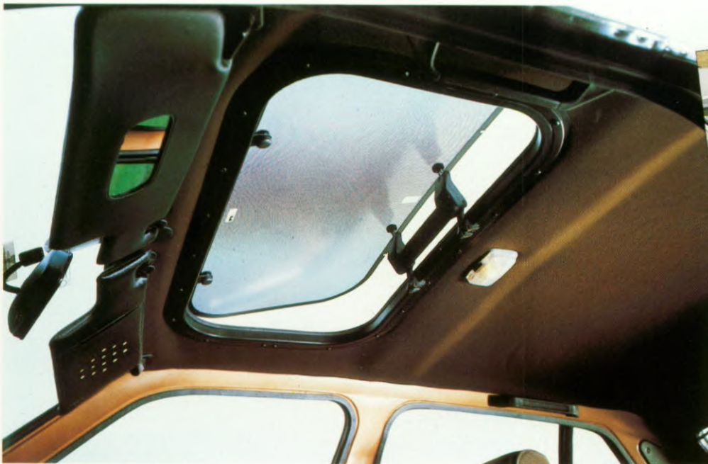
Sunroof open dak voor Visa, GSA en CX. Uniek eigenlijk ... een open dak dat u, ook als het gesloten is, van de zon laat gementen. Want het is gemaakt van doorzichtig veiligheidsglas met zonnereaster. In één handomdraai open of dicht, in 1½ uur gemonteerd. En de prijs ... is al even zonnig.
