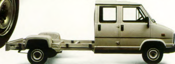
C 25 1300 Chassis met dubbele cabine. Korte wielbasis.
