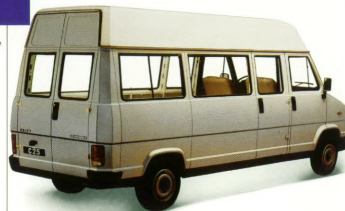
C 25 Bestelwagen met zijruiten 7,7 m 3 . Verhoogd dak. Schuifdeur aan de zijkant verplicht.
