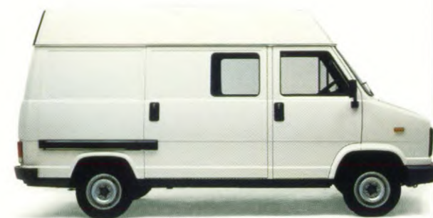
C 25 1300 – Gesloten bestelwagen – 7,7 m 3 (schuifdeur opzij en verhoogd dak als extra).
