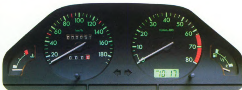
▲ Vanaf de SX uitvoering, heeft het dashboard een elektronische toerenteller en een digitale klok. De VSX uitvoeringen hebben bovendien een watertemperatuurmeter.
