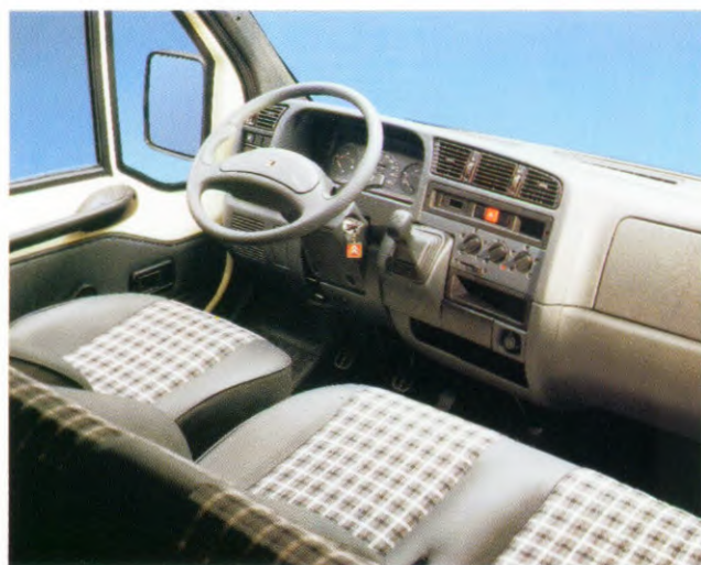
Een dashboard met alles onder handbereik. De vloerpook ontbreekt, zodat de bestuurder gemakkelijk het rechterportier of de laadruimte kan bereiken. De afgebeelde passagiersbank is een optie.
