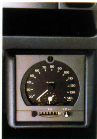
Tachograaf (optie) is wettelijk verplicht indien een combinatie van een trekkend voertuig en aanhanger gezamenlijk een GVW heeft van minimaal 3500 kg.
