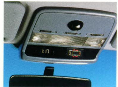
Het digitale scherm (op SX en VSX) geeft de tijd aan en waarschuwt bij niet goed gesloten deuren.
