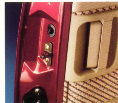
Kindersloten op de twee schuifdeuren voorkomen dat de deuren onbedoeld kunnen worden geopend.
