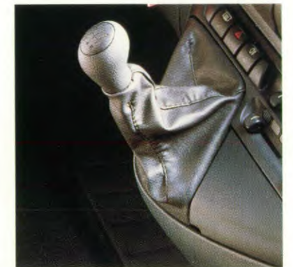
De in het dashboard geïntegreerde versnellingspook bevordert snel en exact schakelen én een ongehinderde doorgang tussen de stoelen.
