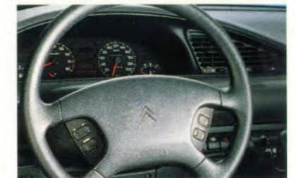
Dankzij bediening op het stuur kunt u de autoradio afstemmen zonder uw handen van het stuur en uw ogen van de weg te nemen. Voor deze optionele voorziening is voldoende plaats naast de standaard airbag voor de bestuurder.
