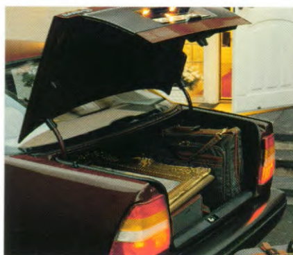
Het kofferdeksel, dat door het indrukken van een knop vanuit de bestuurdersstoel kan worden geopend, loopt tot aan de bumper door waardoor men gemakkelijk toegang heeft tot de bagageruimte die tot de grootste in zijn soort behoort.
