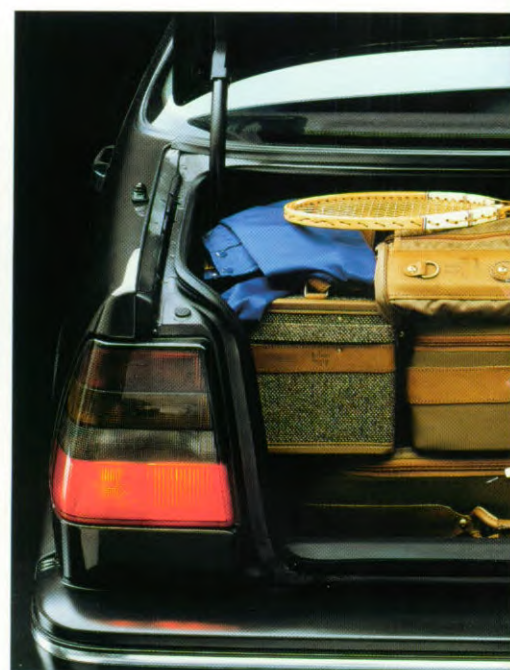
Het kofferdeksel, dat door het indrukken van een knop vanuit de bestuurdersstoel kan worden geopend, loopt tot aan de bumper door waardoor men gemakkelijk toegang heeft tot de bagageruimte die tot de grootste in zijn soort behoort.
