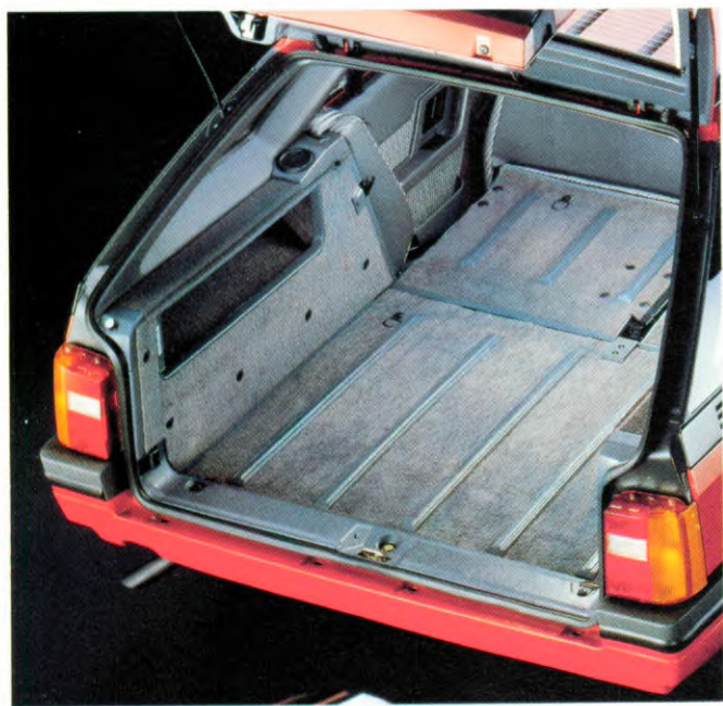
Door de neerklapbare achterbank wordt de capaciteit van de kofferruimte aanzienlijk vergroot.
