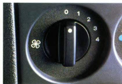
De verwarming/ ventilatie heeft vier snelheden.
