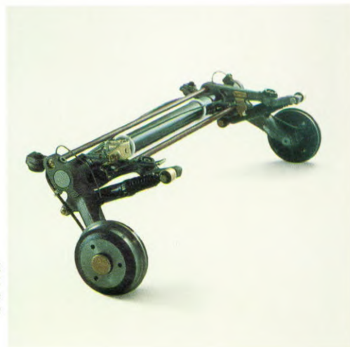
De achterwielophanging met torsiestaven heeft geen nadelig effect op de ruimtecapaciteit van de kofferruimte.
