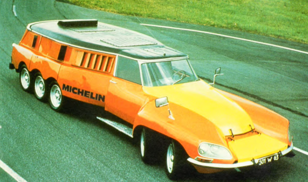
De Citroën met 10 wielen, waarmee Michelin zware bandentests uitvoert.
