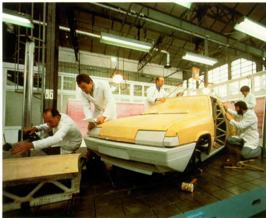
Een essentieel onderdeel bij de productie van ieder nieuw type Citroën, is het maken van een kleimodel op ware grootte.
