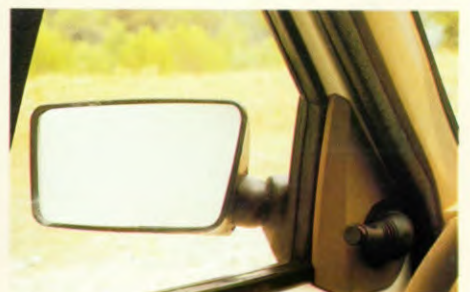
Van binnenuit verstelbare buiten- spiegel voor de bestuurder
