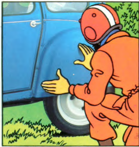
MONTAGE KAN NIET GEMAKELIJKER; DE CARROSSERIEPLATEN VAN DE 2CV ZITTEN GEWOON MET BOUTEN VAST . . .
