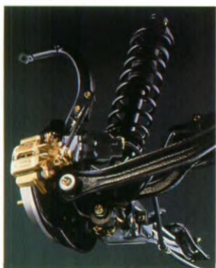
Onafhankelijke 'double wishbone' draagarmen vóór en achter.
