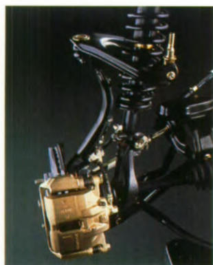
Onafhankelijke 'double wishbone' draagarmen vóór en achter.
